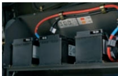
La TUCANO est équipée de trois batteries : deux en série pour l'électronique moteur 24 V, une pour l'alimentation du réseau de bord 12 V.
