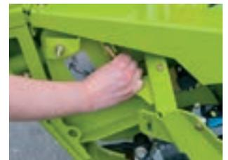
Système de verrouillage rapide des diviseurs et des scies à colza sans outils
