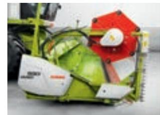
Tablier de coupe sorti – avec scies à colza (+ 600 mm)
