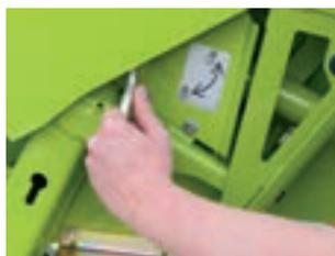
Système de verrouillage rapide des diviseurs
