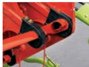
Nouveaux supports des paliers de rabatteurs et nouvelles barres de rabatteurs anti-enroulement de matière
