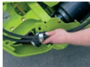
Les flexibles hydrauliques d'entraînement des scies à colza s'accrochent facilement.
